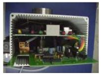
C) 拉出自清洗的电路板, 查看清洗频率设置的跳线;
